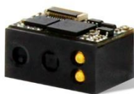
Newland NLS-EM3396 2D IMG 스캔거리 : 6~29cm 규격 : 21.5*15.3*11.8mm 무게 : 5g
