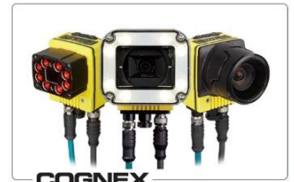
COGNEX In-sight 7000 series 비전 시스템 렌즈 : 자동초점 C,S-mount 내구성 : IP67
