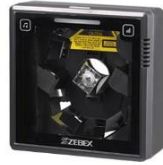
ZEBEX Z-6182 1D CCD 스캔거리 : 0~24cm 내구성 : 1M 낙하테스트 무게 : 685g
