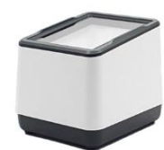
Newland NLS-FR2080 2D IMG 스캔창 : 82x64mm (해상도 5mil) 동작온도 : -20~60°C 무게 : 296g
